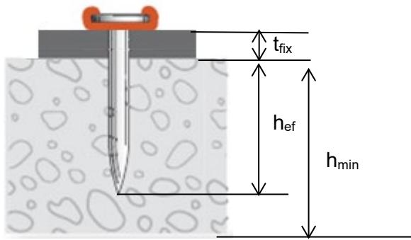
$h_{ef}$  : Profondeur d'implantation
